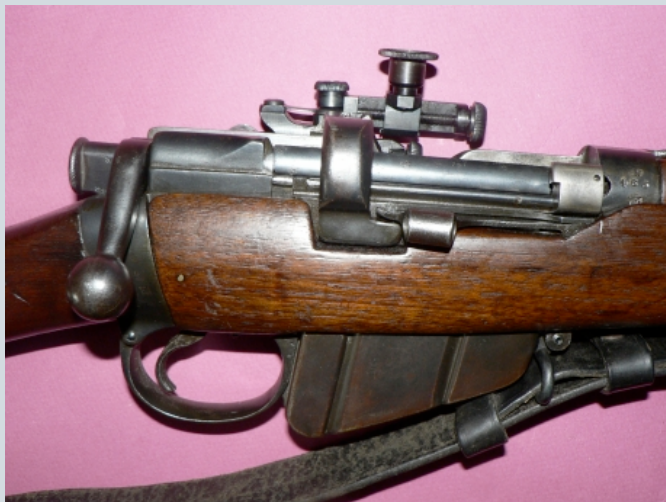
La hausse réglable en hauteur et en dérive présente obligatoirement sur tout les modèles de conversion
