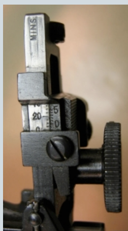
Une hausse micrométrique ancêtre de la 8/53 Parker Hale qui viendra 10 ans plus tard
