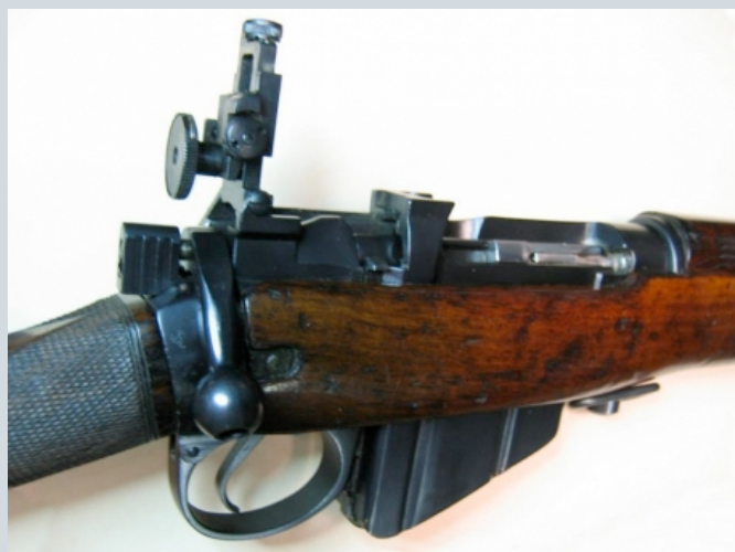
Une hausse micrométrique ancêtre de la 8/53 Parker Hale qui viendra 10 ans plus tard
