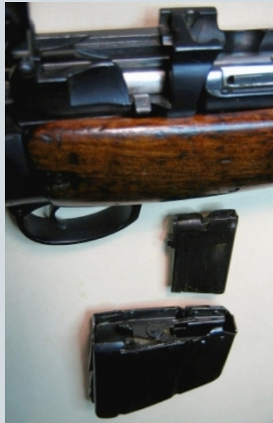
Une carabine à répétition manuelle avec un système de chargeur de 303 British avec l'adaptation d'un petit chargeur de 22 lr équipé d'une rampe pour la munition
