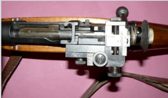
Iris avec ouvertures focale, 6 filtres de couleur, pare soleil et loupe de x 2,5
