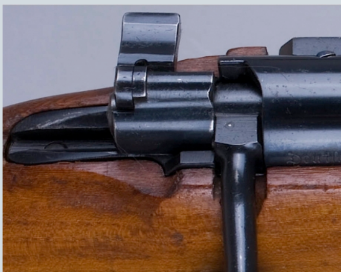
Détail de la culasse et de la sécurité en drapeau
