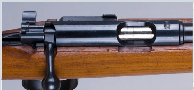
Détail de la culasse et de la sécurité en drapeau
