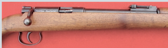
Détail de la culasse et de la sécurité en drapeau
