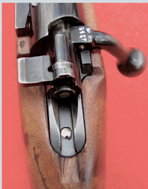
Détail de la culasse et de la sécurité en drapeau
